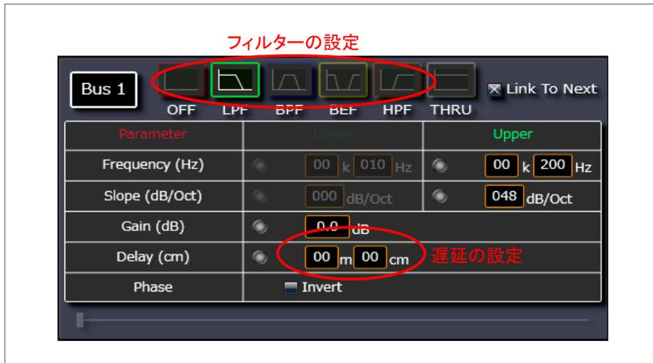
測定を行う場合は、スピーカー補正と室内補正を無効にします。また、金属の振動版のユニットなどは、高域を通過させると大きな分割振動が発生し、測定時に入力クリップする可能性があるため注意が必要です。
