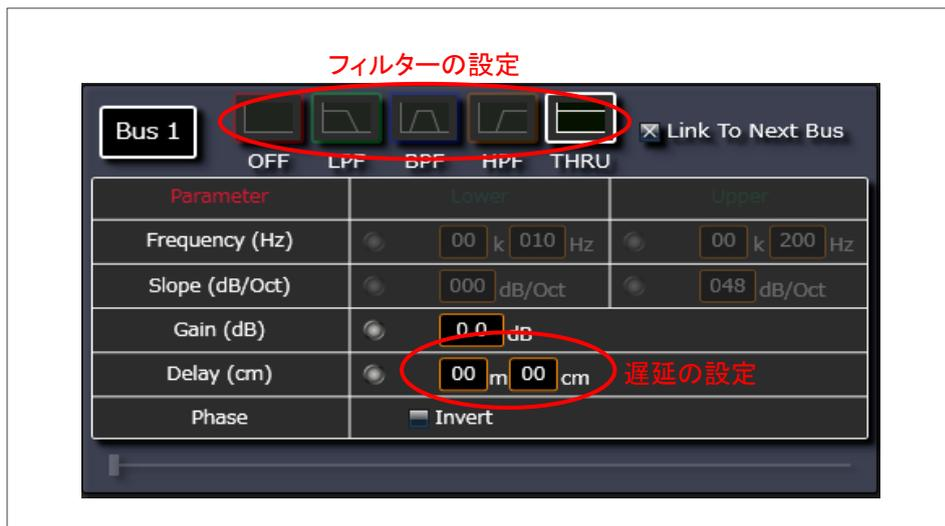
測定を行う場合は、スピーカー補正と室内補正を無効にします。また、金属の振動版のユニットなどは、高域を通過させると大きな分割振動が発生し、測定時にクリップを起す可能性があるため注意が必要です。
